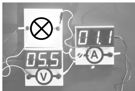
Рисунок – Установка по измерению сопротивления лампы с помощью вольтметра и амперметра
