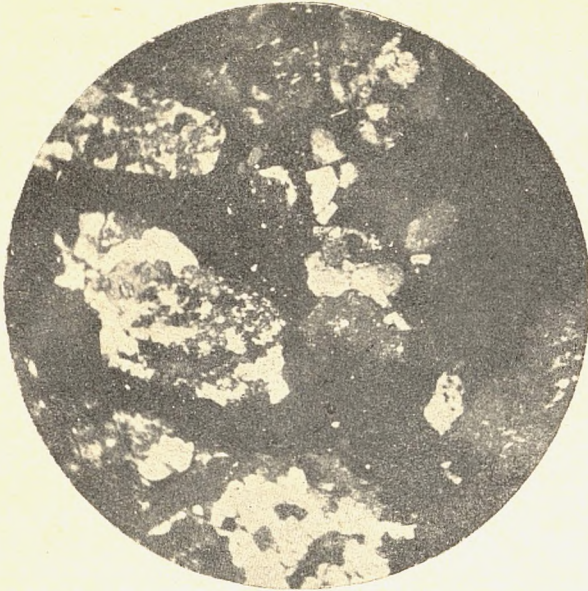
Фиг. 1. Гельсинкит, альбито-эпидотовый гранит. Эпидот в виде агрегата зерен располагается внутри идiomорфных кристаллов плагиоклаза. \times 35 . Николи +.
