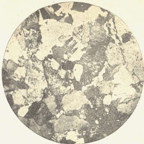
Фиг. 1. Гельсинкит — альбито-эпидотовый гранит. Агрегаты зерен эпидота располагаются на контактах между другими зернами породы. \times 35 . Николи +.
