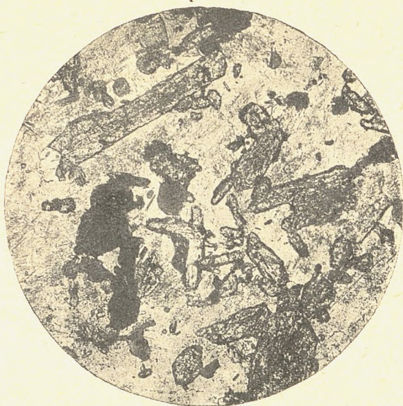
Фиг. 1. Амфиболовый габбро-сиенит. Район Лу-цу-коу (хребет Бей-шань). Обр. 2420. \times 20 . Без анализатора.
