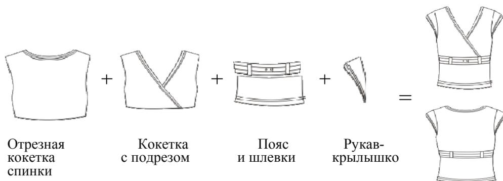
Рис. 4. Формирование модели блузки из систематизированных функционально-конструктивных элементов
