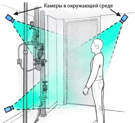
Рисунок 8. Внешнее отслеживание
