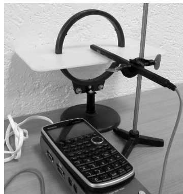
Рис. 1. Калькулятор Casio с датчиком магнитного поля
